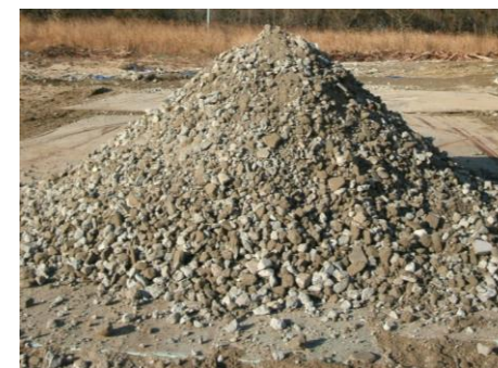
破碎後のコンクリートガラ (CSG材・最大粒径60mm程度)
